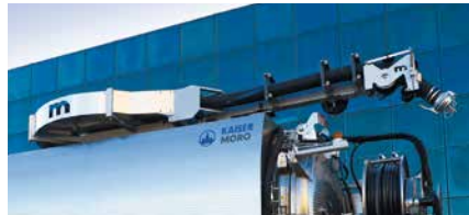
Auf dem Tank montierter Saugschlauchhaspel
