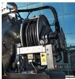
Naspo alta pressione per grandi metrature di tubo alta pressione
